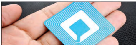
ریز تراشه آراف آی دی به شکل برچسب
