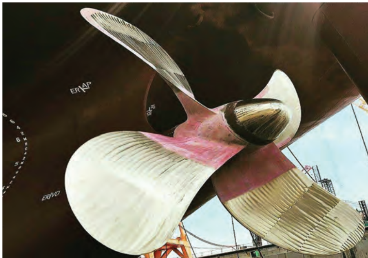
شکل ۱۳- پروانه کشتی با چهار پره
