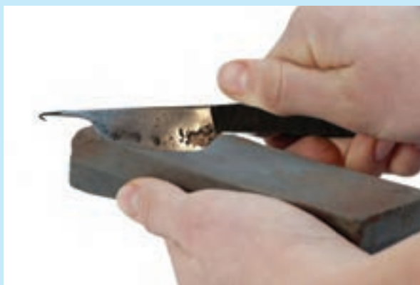
تیز کردن قلاب با سنگ نفت
