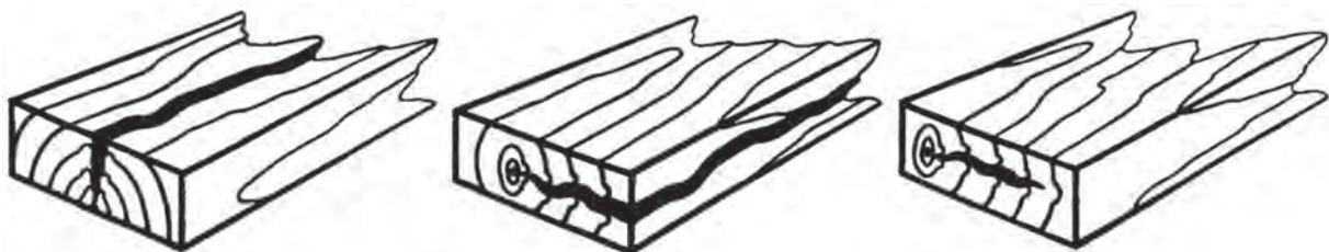
شکاف چوب در اثر سرمای شدید
