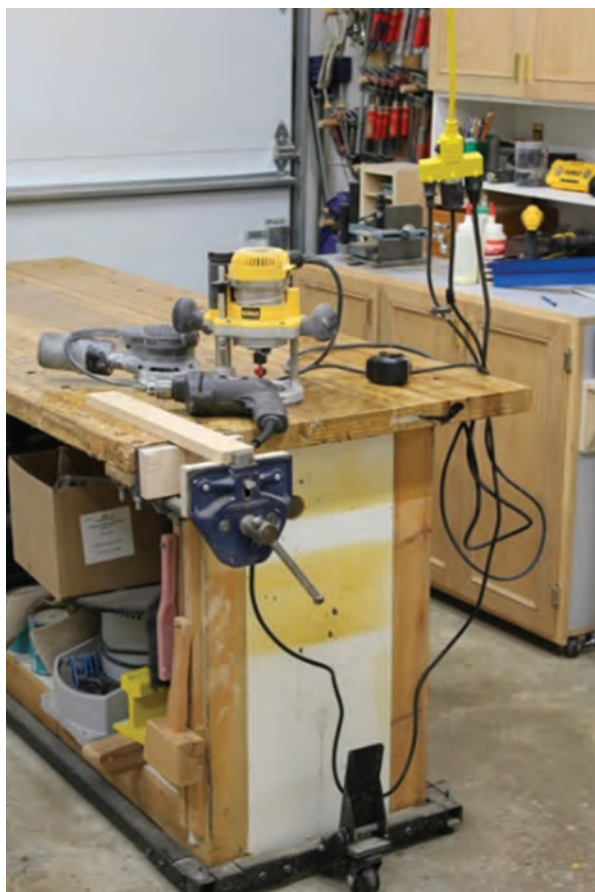
استفاده از پریز سقفی (منظم بودن سیم‌ها)
