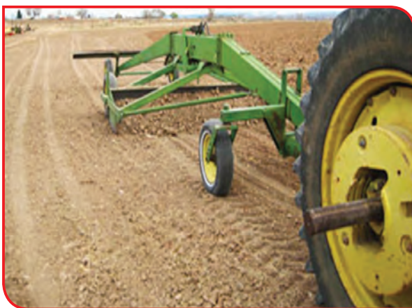
صاف و هموار کردن زمین با ماشین
