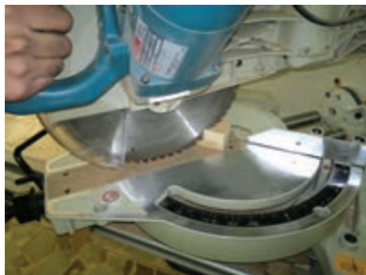
شکل ۲۲- بریدن دو قطعه با هم
