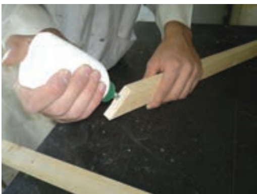
شکل ۲۴-چسب زدن سر قطعات
