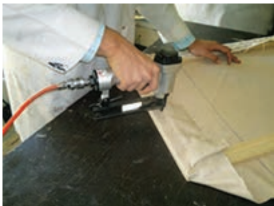
شکل ۳۶- منگنه زدن وسط قاب در ضلع دیگر
