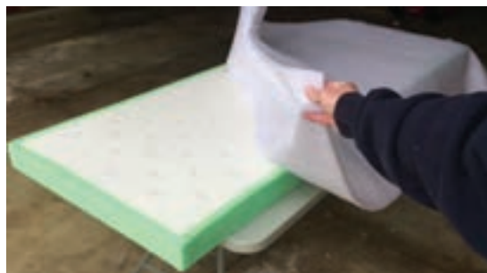
شکل ۶۰- پوشش اسفنج با یک لایه گان
