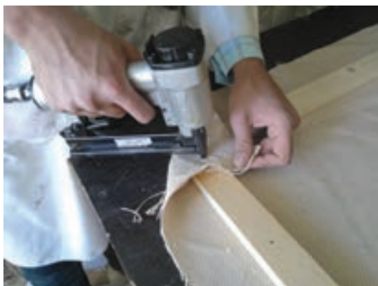
شکل ۳۲- منگنه زدن گوشه قاب
