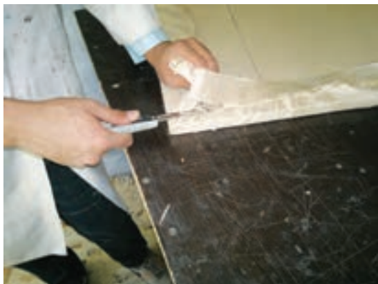
شکل ۳۸- برش پارچه اضافه با کاتر
