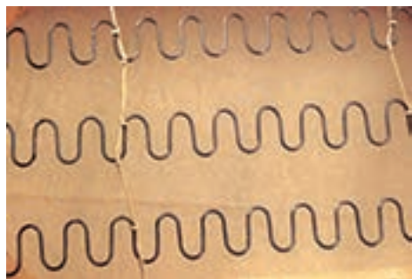
شکل ۷۴ - فنر زیگزاگ (سینوسی)
