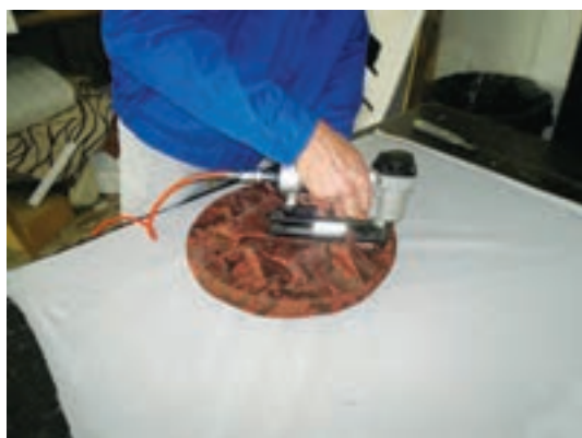
شکل ۱۱۸- منگنه کاری دورها
