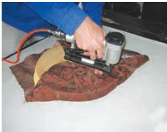
شکل ۱۱۷- منگنه زدن چهارطرف و ثابت کردن پارچه
