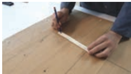
شکل ۳۷- ترسیم دایره بر روی تخته چندلایه
