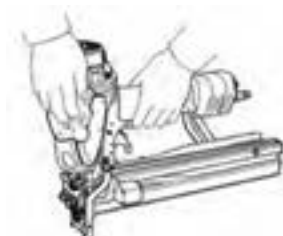
شکل ۱۰۸- پاک کردن دستگاه با دستمال روغنی
