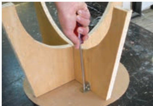
شکل ۶۷- مراحل مونتاژ چهارپایه
