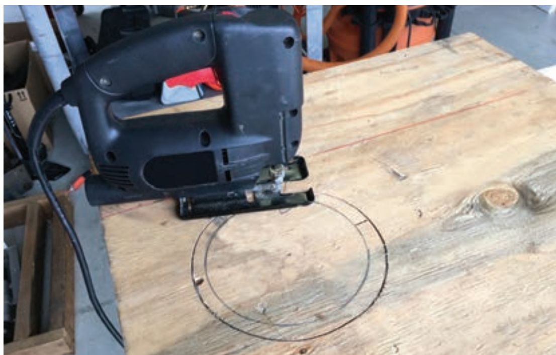
شکل ۵۱- برش داخل قطعه کار
