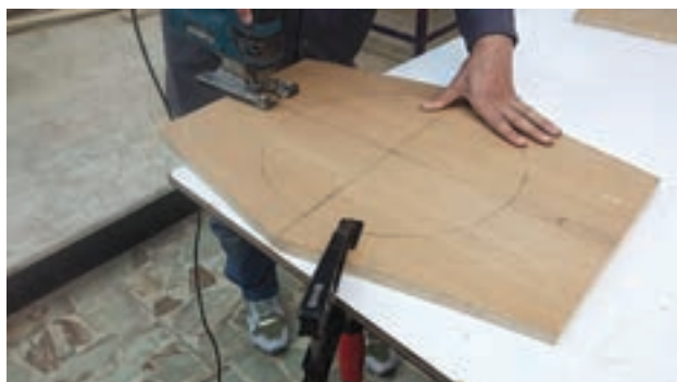
شکل ۴۹- محکم بستن قطعه کار
