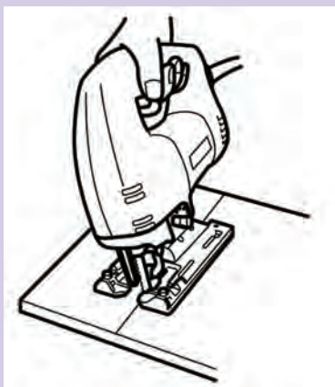
شکل ۴۲- برش زاویه‌دار
