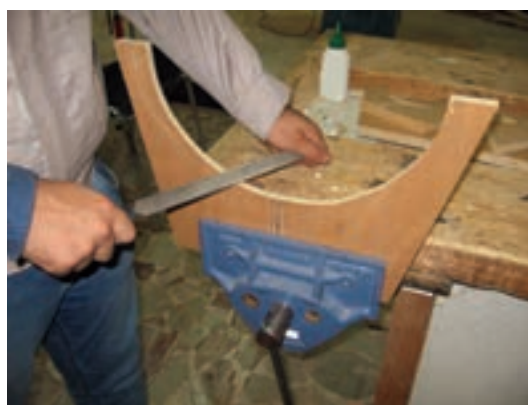
شکل ۶۳- پرداخت با چوبسای زبر
