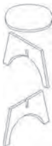
شکل ۳۰- نقشه انفجاری چهارپایه
