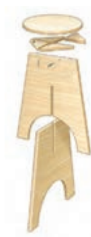
شکل ۳۰- نقشه انفجاری چهارپایه
