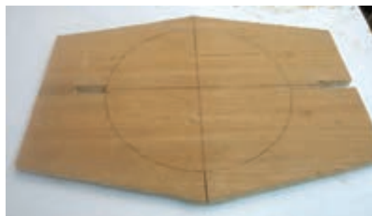
شکل ۶۰- شکاف پایه‌ها به صورت برش خورده
