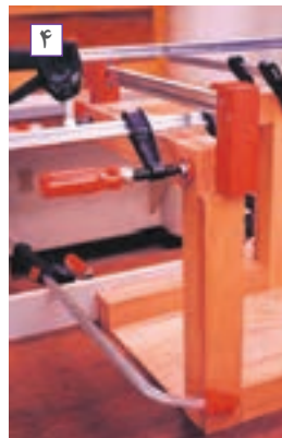
شکل ۲۷- مراحل مونتاژ میز جلوی مبل
