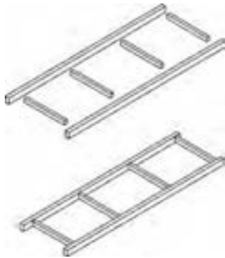
شکل ۳۸- تصویر مجسم ایزومتریک و نقشه انفجاری یک قطعه از پاراوان
