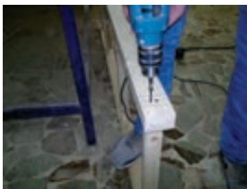
شکل ۵۷- بستن پیچ با دریل
