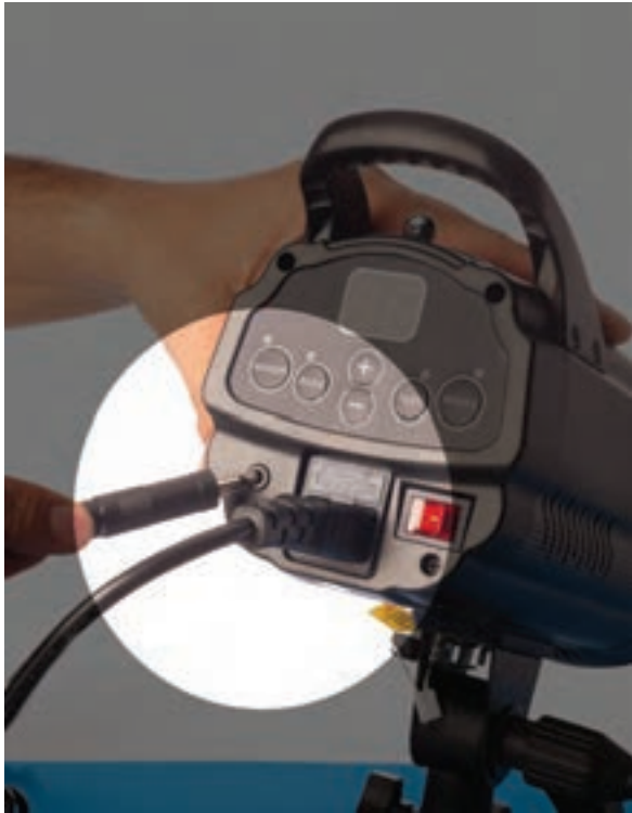
▲ اتصال سیم سینکرون رادیوتریگر به فلاش | تصویر ۱۳۶
