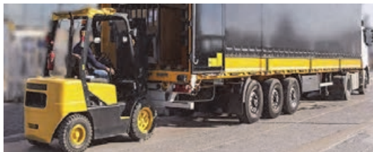
شکل ۱۰- بارگیری کامیون توسط لیفتراک
