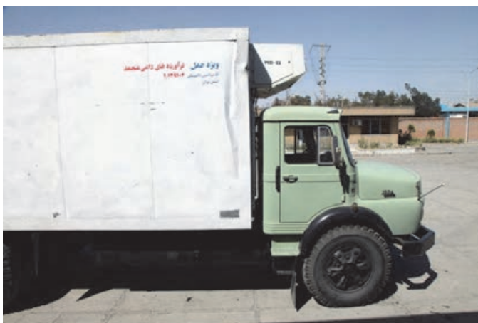
شکل ۳۴- پلاک مخصوص وسایل‌نقلیه حمل مواد فاسدشدنی
