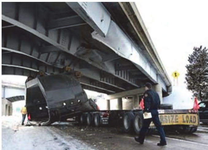
شکل ۲۶- عدم توجه به محدودیت ارتفاعی
