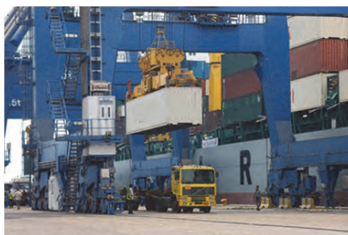
شکل ۸- بارگیری از کشتی به کامیون با جرثقیل
