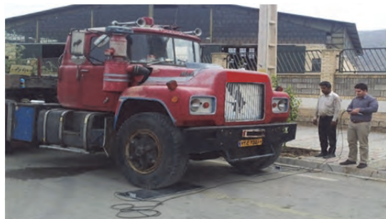
شکل ۴- باسکول محورکش متحرک
