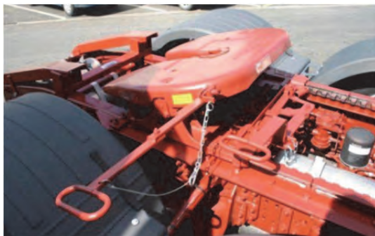
شکل ۱۲- نمونه‌ای از صفحه ریش
