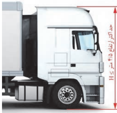
شکل ۴- حداکثر ارتفاع تعیین شده برای وسایل نقلیه
