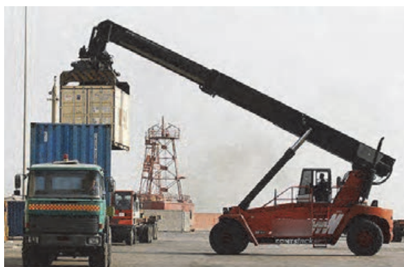
شکل ۱۲- بارگیری کامیون توسط ریچ استراکر
