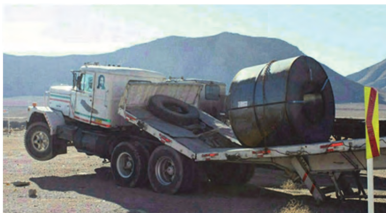
شکل ۲- عدم توزیع مناسب بار بر گروه‌های محوری
