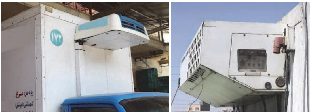
شکل ۲۱- تجهیزات سرمایشی نصب شده بر روی وسیله‌نقلیه
