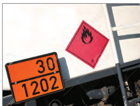
شکل ۳۶- نحوه نمایش تابلوی نارنجی رنگ بر روی وسایل نقلیه حمل مواد خطرناک
