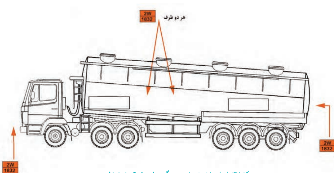
شکل ۳۷- انواع تابلوهای نارنجی رنگ مواد خطرناک از لحاظ نحوه نصب
