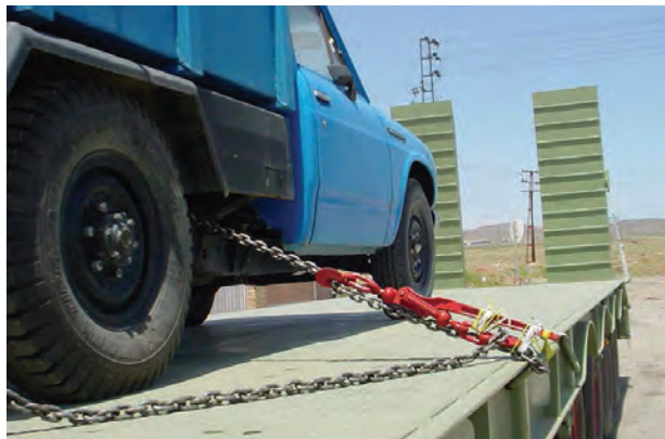
شکل ۲۲- نمونه‌ای از مهار نادرست یک اتومبیل
