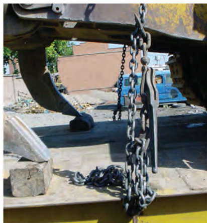
شکل ۲۷- بستن قسمت‌های مفصلی ماشین‌آلات راه‌سازی
