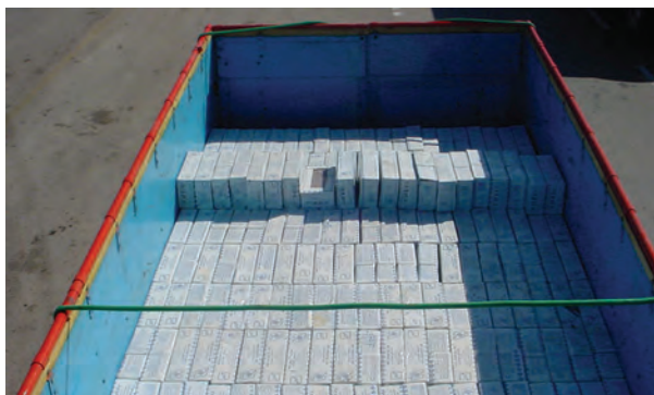
شکل ۵۴- نحوه پک کردن بارهای محاط
