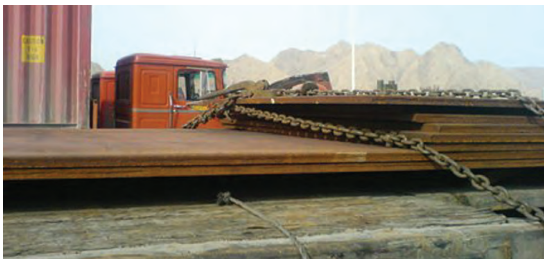
شکل ۳۴- نمونه‌ای از مهار نادرست ورق (بار تخت) توسط زنجیر
