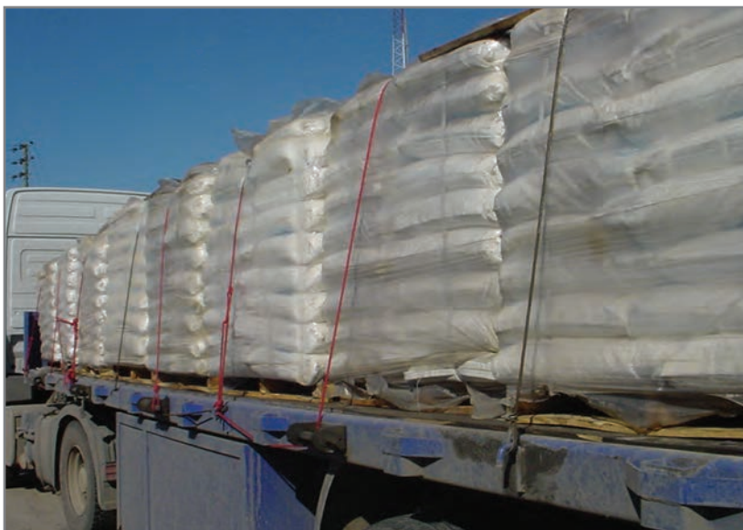
شکل ۴- نمونه‌ای از مهار نامناسب پک‌ها به وسیله طناب
