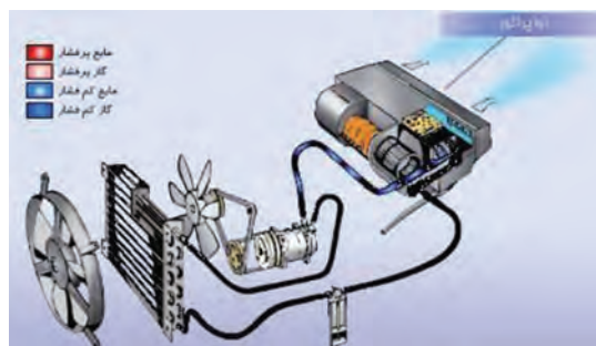
شکل ۲۵ - مدار و اجزای کولر وسیله نقلیه
