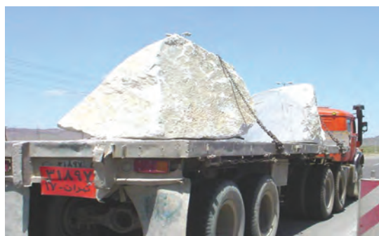
شکل ۱۷- نمونه‌ای از مهار نادرست سنگ‌ها
