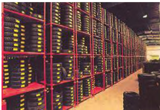
شکل ۱۱- انبار کردن صحیح تایر
