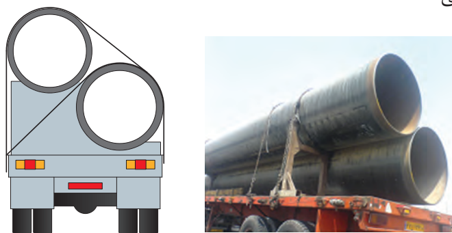
شکل ۵۳- نمونه‌ای از مهار لوله‌های قطور توسط قید گهواره‌ای خاص (زین)
