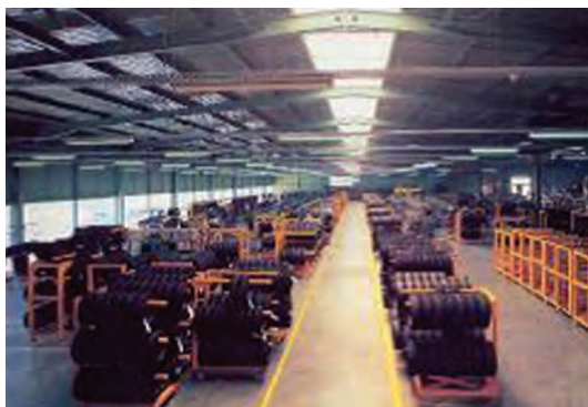
شکل ۱۱- انبار کردن صحیح تایر
