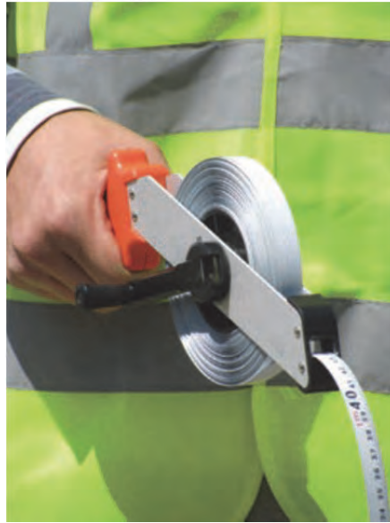
شکل ۱۶- متر کمری ۷/۵ متری و متر فلزی ۵۰ متری
