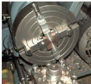
ج: بستن قطعه با مقطع مستطیل در صفحه نظام با فک های تکرو
