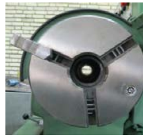
الف: استقرار فک روی پیچ ارشمیدس
