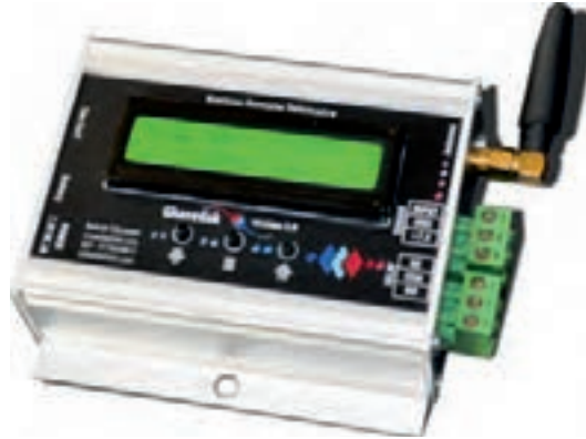
دستگاه کنترل از راه دور دما و رطوبت سالن پرورش قارچ
