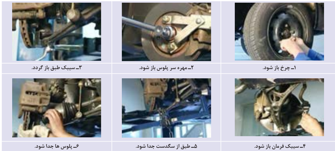
شکل ۹-۹- نحوه بازکردن پلوس
