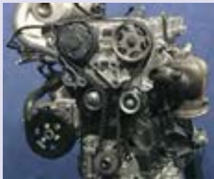
تایم موتور دو میل سوپاپ رو، نوع پولی و تسمه
