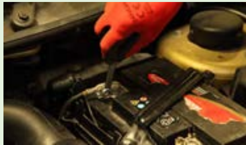
شکل ۱۹-۲- جدا کردن سر باتری
