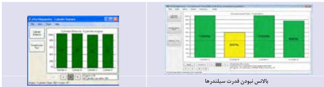
شکل ۸-۲۶- بررسی میزان بالانس در قدرت موتور با کمک دستگاه عیب یاب
