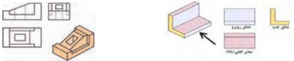
شکل ۸-۵ دو نمونه نقشه سه نما
