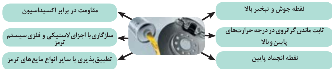
شکل ۲-۶- ویژگی‌های مایع هیدرولیک ترمز
