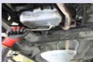
۵- پیچ تخلیه روغن موتور را که در زیر کارت قرار دارد، باز کنید. (نکته: در هنگام تخلیه روغن موتور، به منظور تخلیه بهتر و سریع تر روغن باید در ورودی روغن موتور باز باشد)
