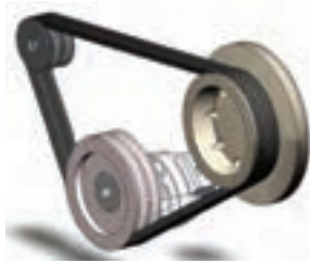
شکل ۲-۲- انتقال توان به کمک تسمه و پولی
