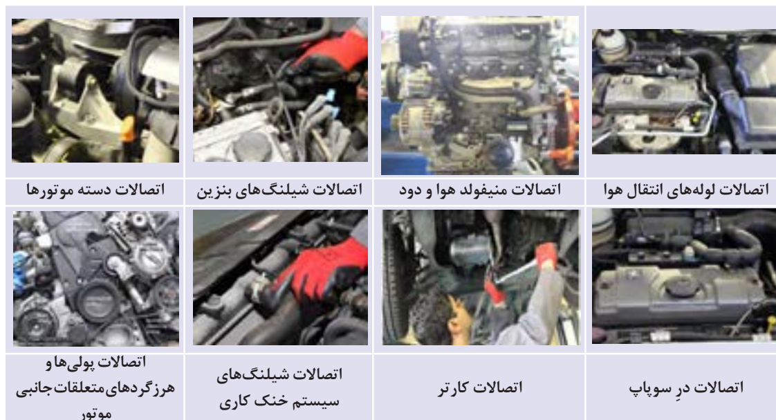
شکل ۱-۲۳ - بخش‌های مختلف سیستم مولد قدرت برای آچارکشی
