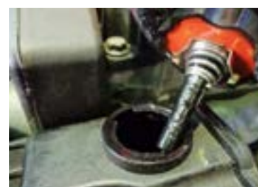
۸- دستگاه و کیوم از مخزن جدا شود و سطح مایع مخزن کنترل شده، در صورت لزوم به آن اضافه شود.
