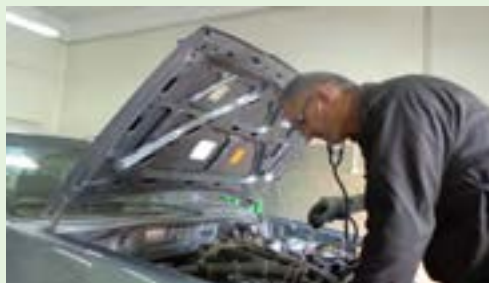
شکل ۲۰-۲- استفاده از گوشی مکانیکی
