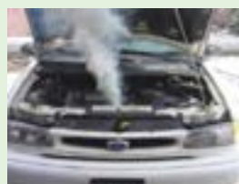
شکل ۱۸-۷- پاشش آب رادیاتور
