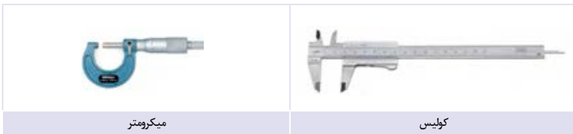
شکل ۱۴-۱ وسایل اندازه‌گیری دقیق
