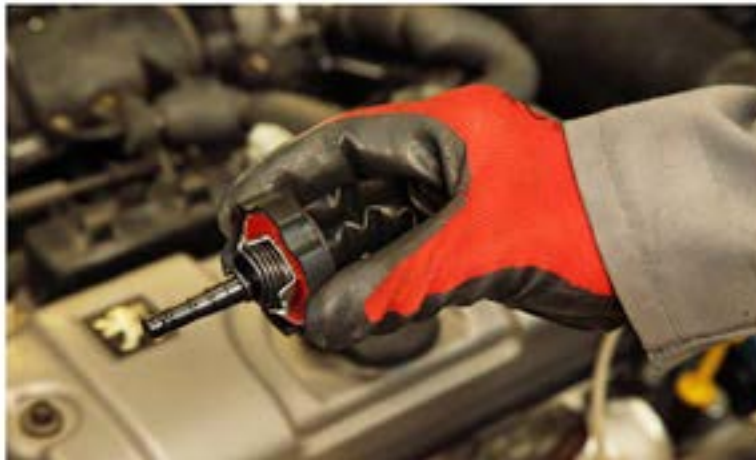
شکل ۵-۹- شاخص‌های روی درپوش مخزن مایع هیدرولیک فرمان
