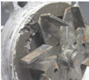
خرابی بلبرینگ و خوردگی داخلی
