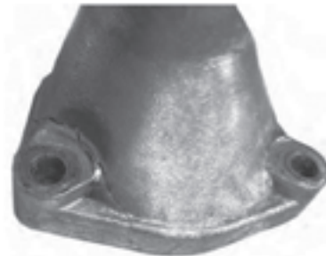
نشستی از مجاری خارجی (خرابی تجهیزات آب بندی)
