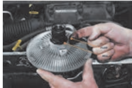
پس از باز کردن: میزان نشتی روغن داخل کلاچ
