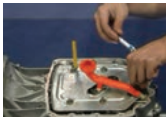
باز کردن صافی روغن ورودی به پمپ
