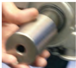
نصب کاسه نمدها با ابزار مخصوص
