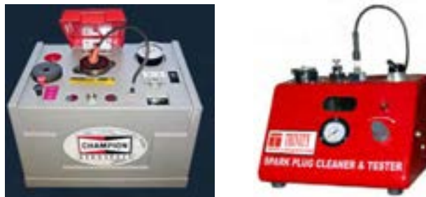
شکل ۲۴-۸- دستگاه شمع پاک‌کن با قابلیت تست شمع
