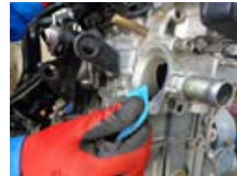
۴- مکان ترموستات تمیز شود.
