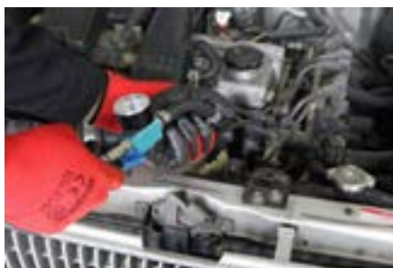
۲- شلنگ یا لوله دستگاه نشتی سنج نصب شود.
