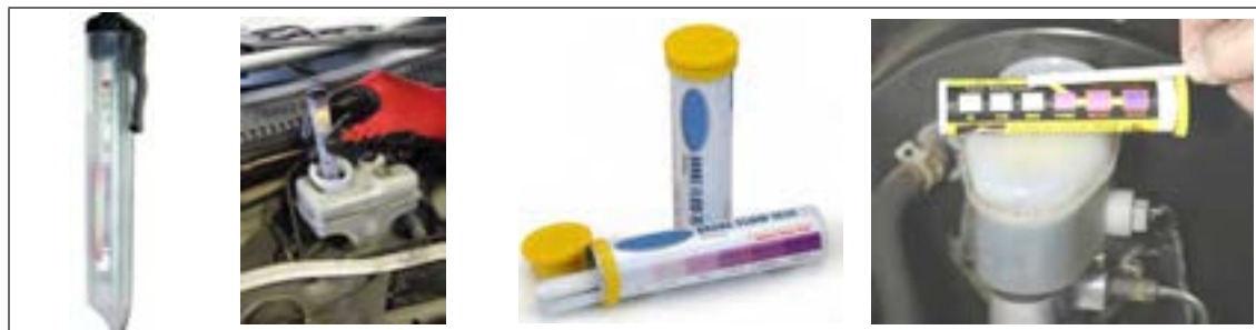
شکل ۶-۷- تست کیفیت مایع هیدرولیک ترمز
