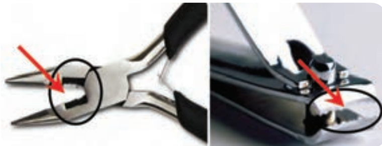
شکل ۱۹- لبه‌های برنده خراب شده در ناخن گیر و دم باریک
