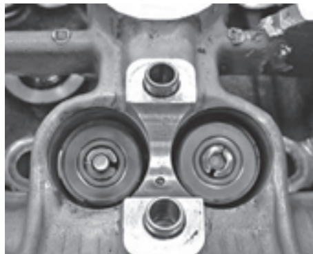
شکل ۱-۱۱۴ نصب نادرست خارهای سوپاپ
