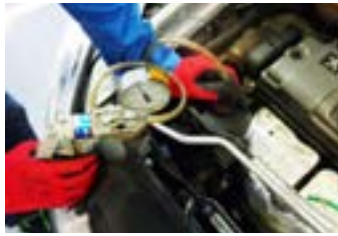
۳- با کمک تبدیل مناسب دستگاه و کیوم دستی روی مخزن ذخیره نصب گردد.
