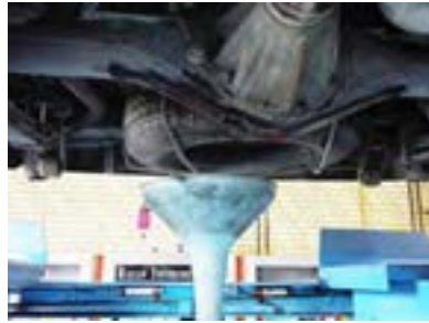
۳- پیچ تخلیه روغن دیفرانسیل باز شود ۴- مخزن جمع آوری روغن مستعمل زیر خودرو قرار گیرد.
