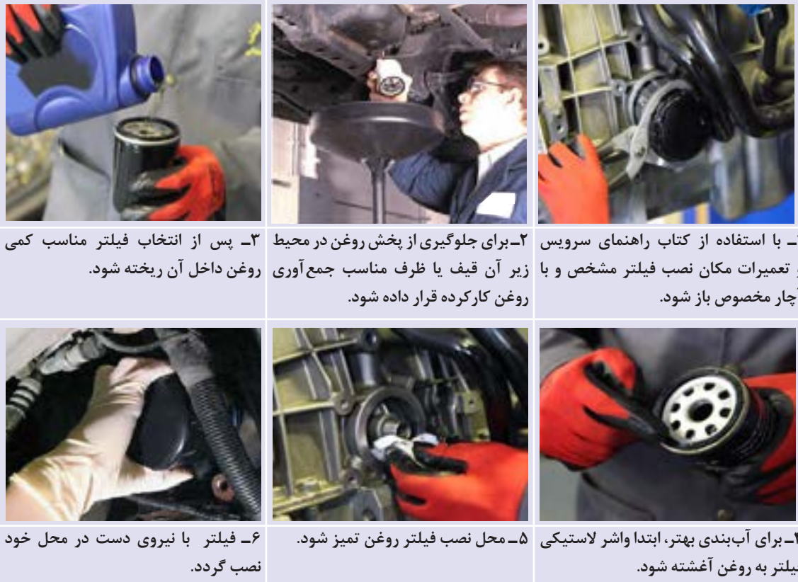
شکل ۱۷-۳- مراحل تعویض فیلتر روغن
