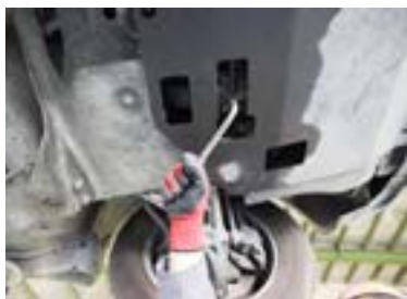
۴- پیچ تخلیه روغن جعبه دنده باز شود.
