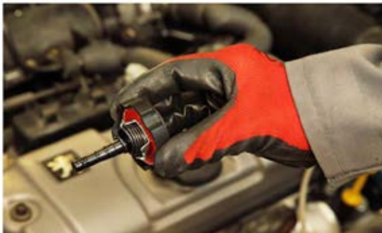
شکل ۹-۵- شاخص‌های روی درپوش مخزن مایع هیدرولیک فرمان
