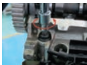
جهت باز کردن پیچ های سرسیلندر
