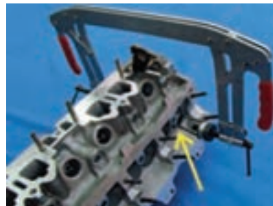
استفاده از فنر سوپاپ جمع کن مخصوص سرسیلندر موتور پژو
