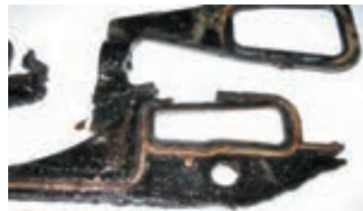
سوختن واشر آب بندی مانیفولد
