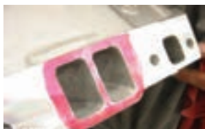
تابیدگی در مانیفولد ورودی
