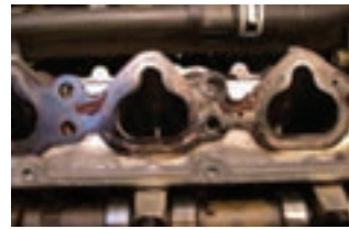
آثار نشتی مانیفولد دود روی سرسیلندر
