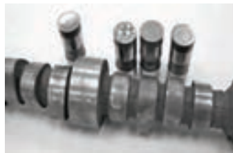
خوردگی تاپیت و بادامک‌های میل سوپاپ
