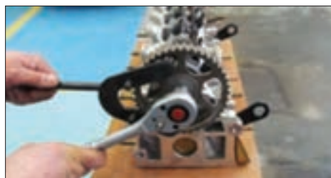
مراحل باز کردن چرخ تسمه
