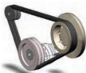
شکل ۲-۲- انتقال توان به کمک تسمه و پولی
