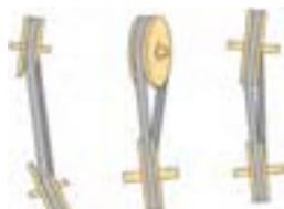
شکل ۱۶-۲- غیرهم‌راستایی محوری و زاویه‌ای پولی‌ها
