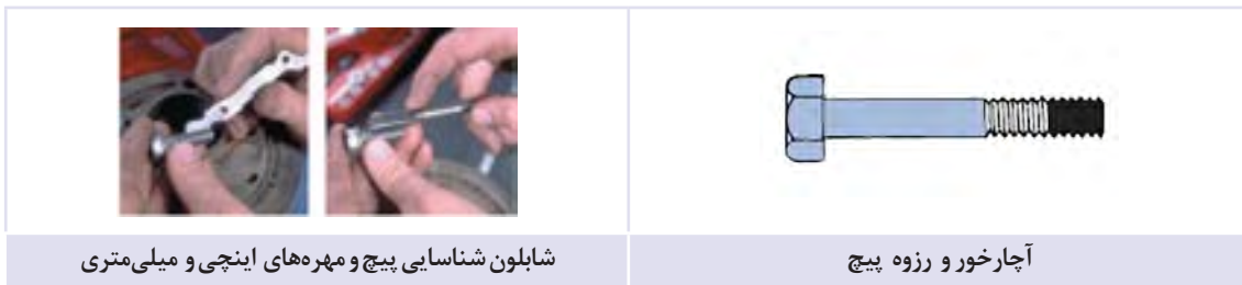
شکل ۱۳-۱ - شناسایی رزوه پیچ
