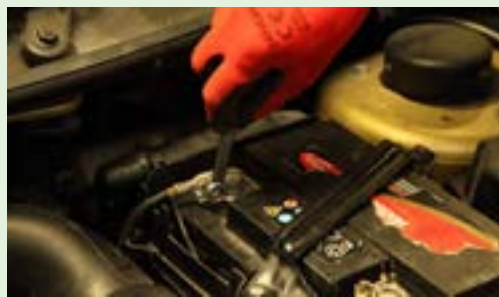
شکل ۱۹-۲- جدا کردن سر باتری
