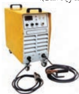
شکل ۱۳- ترانسفورماتور جوش برق
