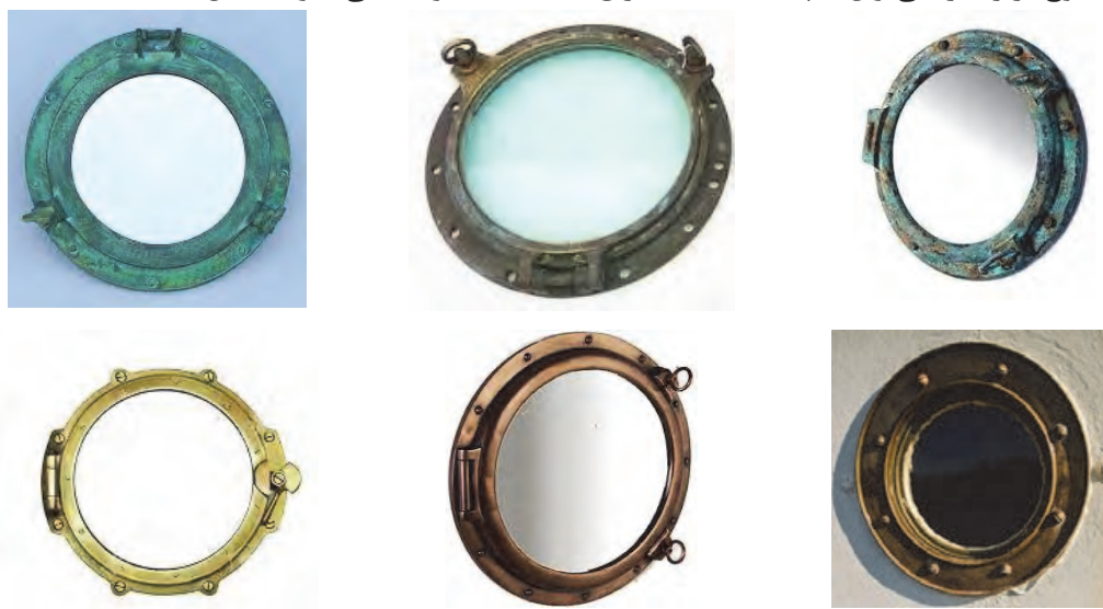
شکل ۹-۱ خوردگی برنج (ردیف بالا) و پس از زنگ‌زدایی (ردیف پایین)
