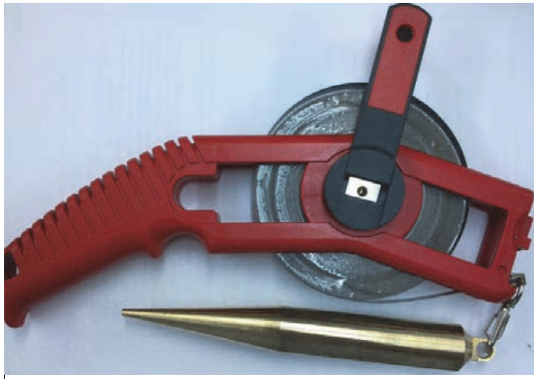
شکل ۶-۳- Sounding tape برای اندازه‌گیری سطح مخزن
