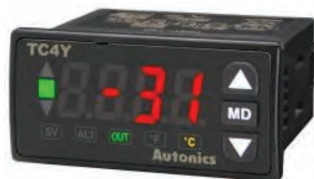
تصویر ۳۲- ترموستات دستگاه جوجه کشی
