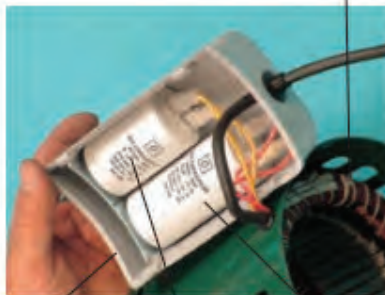
خازن ۱۴ میکروفارادی سرعت زیاد خازن ۹ میکروفارادی سرعت کم درپوش خازن‌ها
