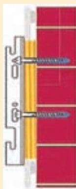
دتایل نصب بست رادیاتور پنل
