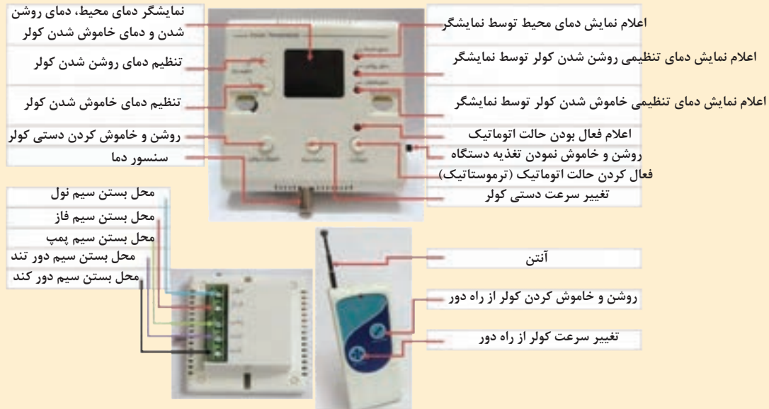
مدار کلید هوشمند کولر آبی
