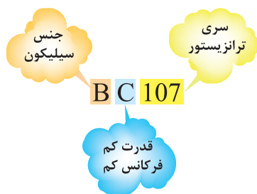
شکل ۳۱-۱۴- مشخصات ترانزیستور BC107
