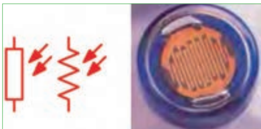
شکل ۹۵ — ۱ مقاومت تابع نور و نماد آن
