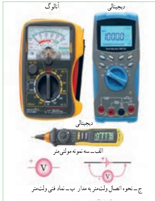
شکل ۱-۵۵- ولت متر و نماد آن
