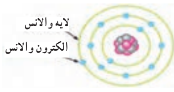
شکل ۹-۱ لایه‌ها و الکترون و الانس
