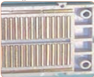
شکل ۸۹-۱- اتصالات داخلی برد بُرد
