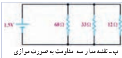
شکل ۶۶-۱ - سه مقاومت به صورت موازی
