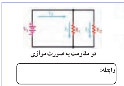
شکل ۶۷-۱ - مقاومت‌ها به صورت موازی
