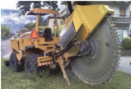
شکل ۱۸- دستگاه برش آسفالت ماشینی
