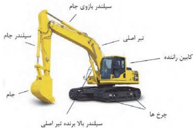
شکل ۵- قسمت‌های مختلف بیل مکانیکی
