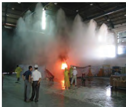
شکل ۱۱-۴- سیستم پاشش آب اطفاء حریق
