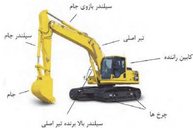
شکل ۵- قسمت‌های مختلف بیل مکانیکی
