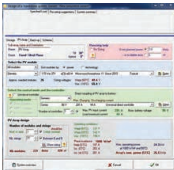
شکل ۳۸ - مقادیر مدول PV، کنترل شارژ
