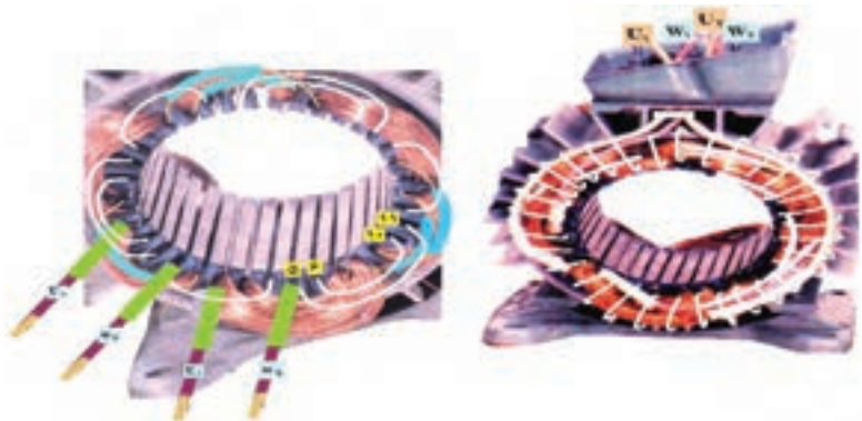
شکل ۳۰- سیم پیچ فاز دوم هدایت سراتصالات به تخته کلم و نخ بندی سیم پیچی
