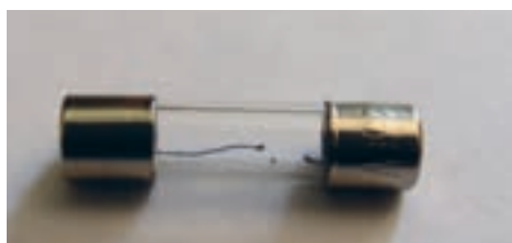
شکل ۱۶ - فیوز آسیب دیده است.
