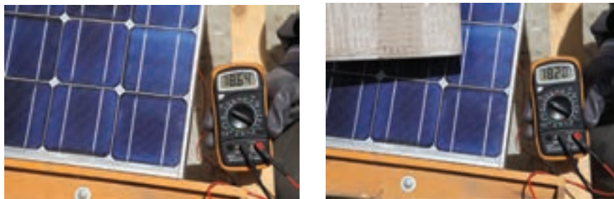
شکل ۷- الف - اثر سایه بر ولتاژ بی‌باری
