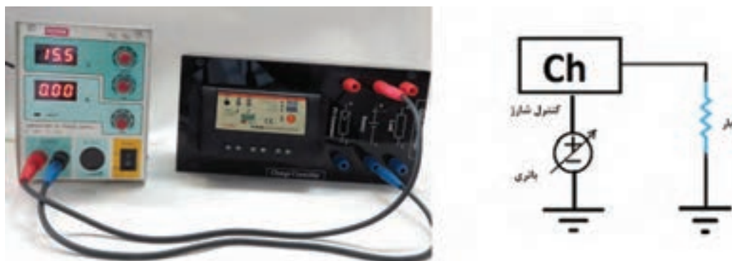
شکل ۱۹- حالت کنترل دشارژ
