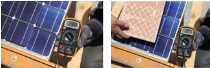
شکل ۷- ب - اثر سایه بر جریان اتصال کوتاه
