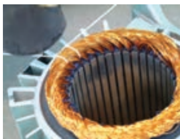
شکل ۵۸- نخ بندی سیم پیچی موتور
