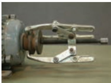
شکل ۱۷- در آوردن پولی از محور موتور
