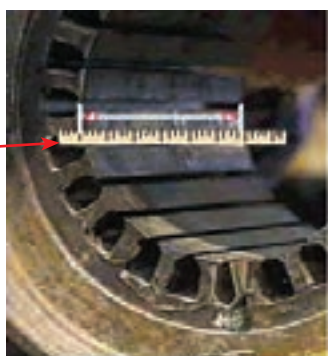
شکل ۲۷- اندازه گیری طول و قطر داخلی استاتور
