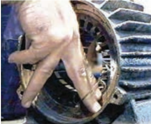
شکل ۳۰- روش تجربی تهیه قالب
