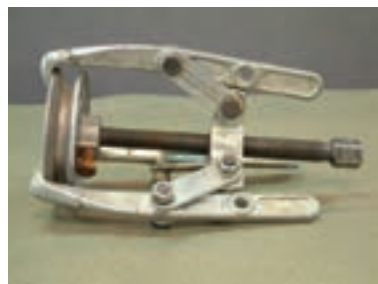
شکل ۱۷- در آوردن پولی از محور موتور
