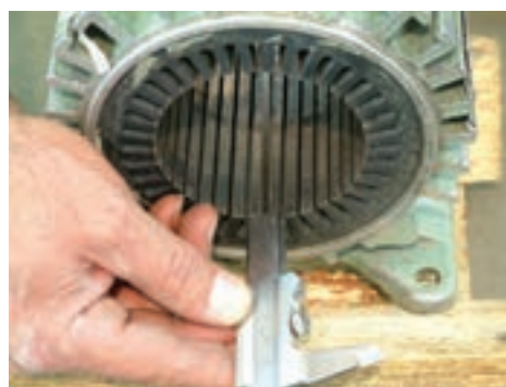
شکل ۲۷- اندازه گیری طول و قطر داخلی استاتور
