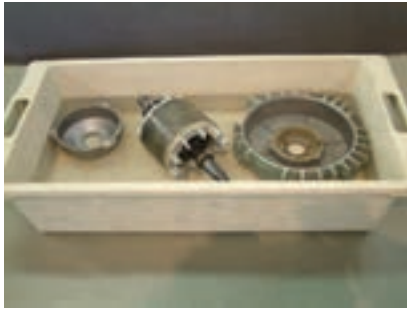
شکل ۲۰- شست و شو و جمع کردن قطعات باز شده
