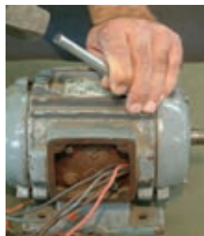
شکل ۱۸- باز کردن پیچ‌های موتور و درپوش‌ها
