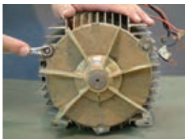
شکل ۱۸- باز کردن پیچ‌های موتور و درپوش‌ها
