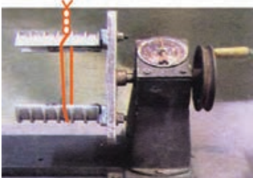
شکل ۳۱- تنظیم فک‌های کلاف پیچ بر اساس قالب تهیه شده
