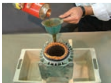
شکل ۶۰- شارلاک زدن سیم پیچی استاتور
