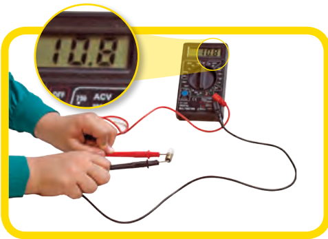
شکل ۸- اندازه‌گیری مقاومت لامپ خاموش با اهم سنج
