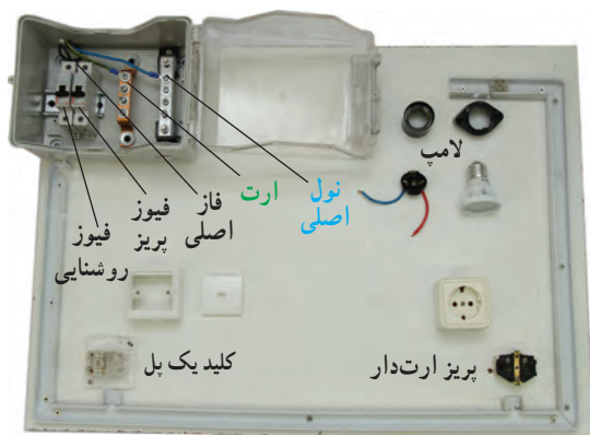
شکل ۷-۵ - پیاده کردن نقشه، جانمایی و داکت کشی
