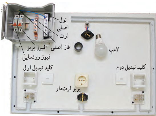
شکل ۲۰-۵- سیم کشی کلیدهای تبدیل
