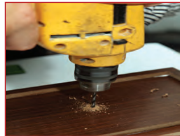
پ- سوراخ کردن در جعبه با دریل
