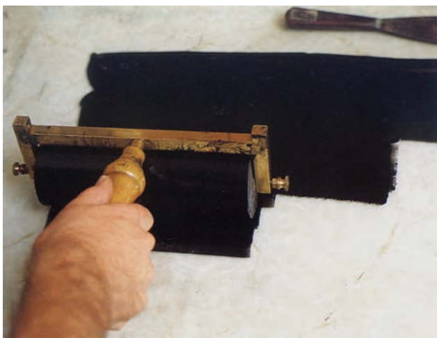
تصویر ۶۰- پخش کردن مرکب روی سطح شیشه
