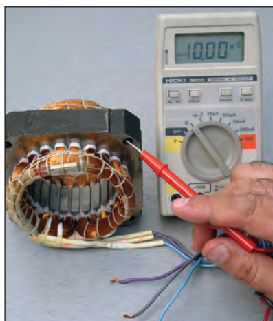
▲ شکل ۱۴-۲- تست اتصال بدنه
