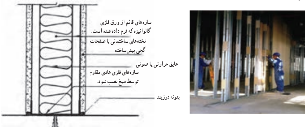
شکل ۴-۱۵- جزئیات دیوار مرکب با پوشش صفحات گچی و نحوه ی اجرای آن
