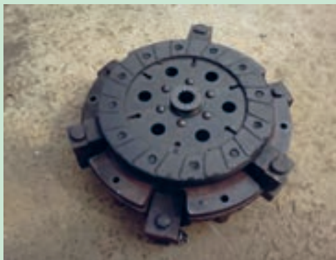
شکل ۲۵. جدا کردن مجموعه کلاچ از فلاپویل
