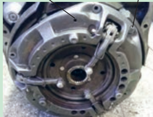
شکل ۲۵. جدا کردن مجموعه کلاچ از فلاپویل
