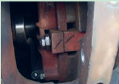
شکل ۲۶. علامتگذاری قطعات مجموعه کلاچ
