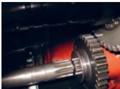
شکل ۲۰. محور تواندهی در حالت خلاص
