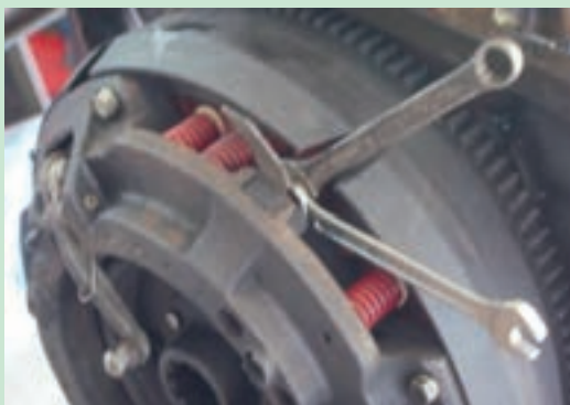
شکل ۳۹. تنظیم کلاچ محور تواندهی
