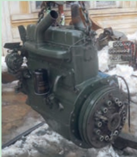
شکل ۲۴. پیاده کردن موتور تراکتور U650
