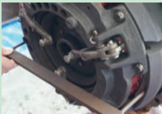
شکل ۳۸. تنظیم انگشتی‌های کلاچ
