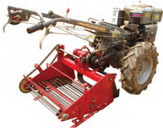
شکل ۷- سیب‌زمینی‌کن نقاله‌ای مخصوص تراکتور دو چرخ
