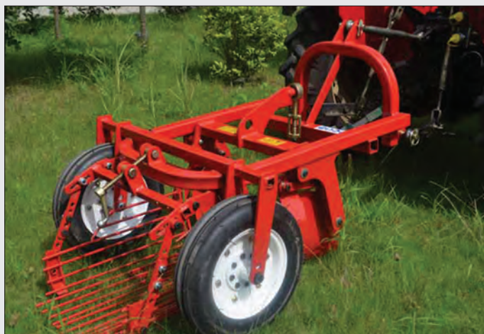
شکل ۱۳- اتصال سیب زمینی کن لرزان به تراکتور
