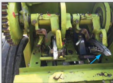
شکل ۹۳- تحویل نخ به نخ گیر
