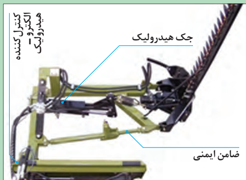
شکل ۱۷- دروگر شانه‌ای با سیستم محرک ارتعاشی
