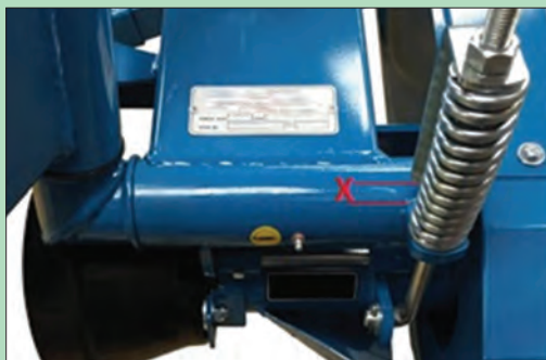
شکل ۲۱- شاخص تنظیم کشش تسمه دروگر استوانه‌ای
