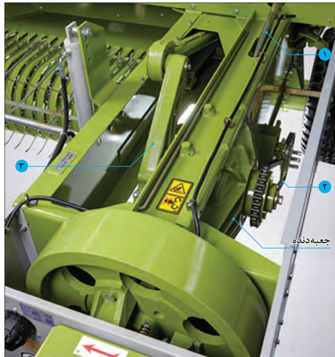
شکل ۸۲- مسیر انتقال توان در بسته‌بند
