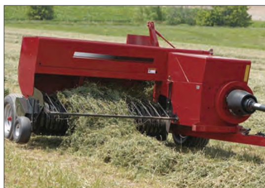
شکل ۷۱- واحد بردارنده بسته بند
