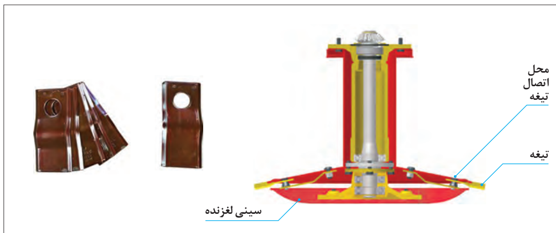
شکل ۴- تیغه و محل قرارگیری آن روی استوانه
