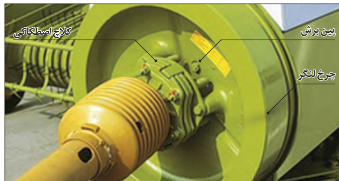
شکل ۸۰- چرخ لنگر و کلاچ ایمنی
