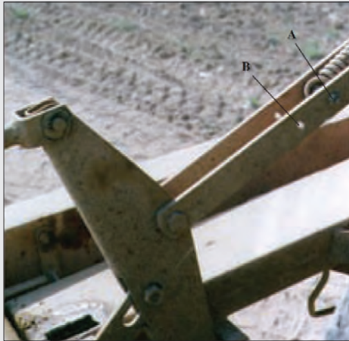
شکل ۳۷- تنظیم فنر شناور
