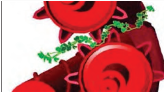
شکل ۵۵- ساقه کوب و طرز کار غلتک‌های آن
