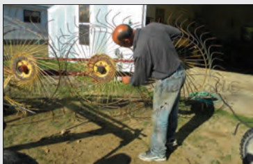
شکل ۵۷- بررسی انگشتی‌ها
