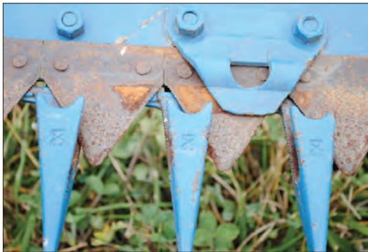
شکل ۱۰- موقعیت انگشتی و تیغه در دروگر شانه‌ای
