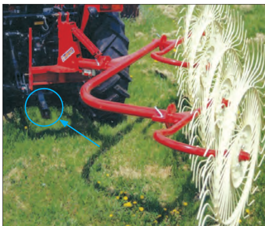
شکل ۵۹- اتصال شانه خورشیدی به تراکتور
