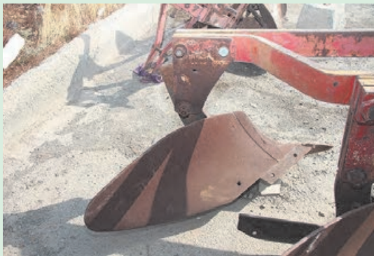
شکل ۲۱-۱. پین بریده شده در گاواهن
