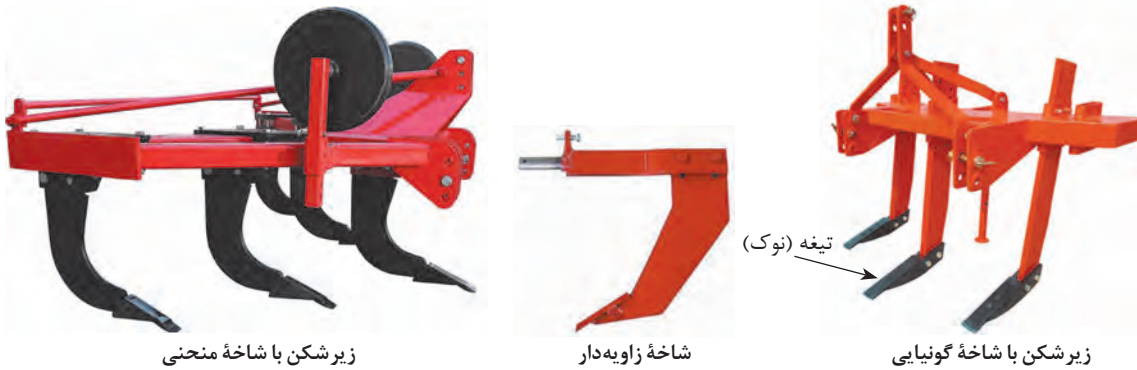
شکل ۱۲-۱. زیرشکن و انواع شاخه‌های آن
