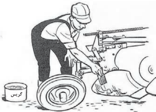
شکل ۵۲-۱. اندود کردن قطعات گاوآهن با مواد ضدزنگ
