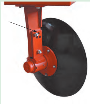
شکل ۴۲-۲. تنظیم زاویه بشقاب
