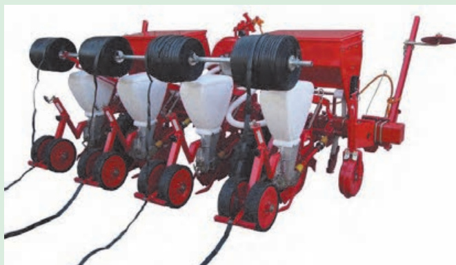
شکل ۲۲-۵. استقرار نوار در مزرعه همراه با ردیف‌کاری
