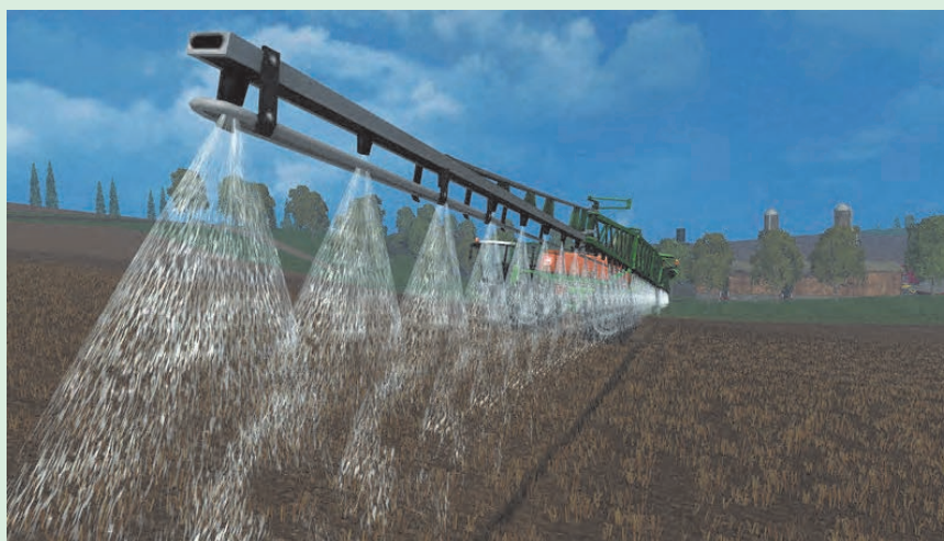
شکل ۴-۴۰. با افزایش ارتفاع میزان همپوشانی و میزان بادبردگی افزایش می‌یابد.
