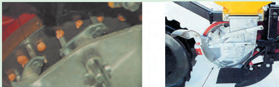
شکل ۳۶-۳. تنظیم تک‌دانه‌کن در ردیف‌کار نیوماتیکی
