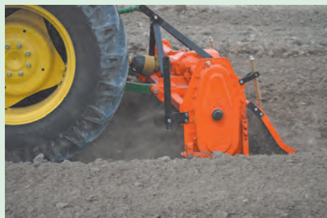
شکل ۴۸-۱. تاثیر درپوش بر خرد شدن خاک
