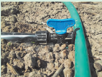
شکل ۱۹-۵. اتصال نوار به لوله و شیر
