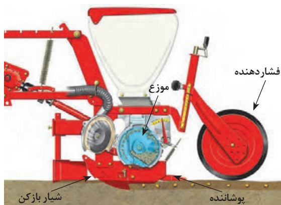
شکل ۱۴-۳. اصول کاشت بذر با کارنده
