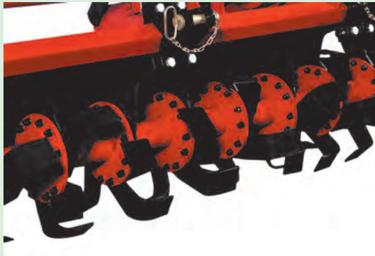
شکل ۲۲-۱. نقاط اتصال تیغه‌ها به فلانچ
