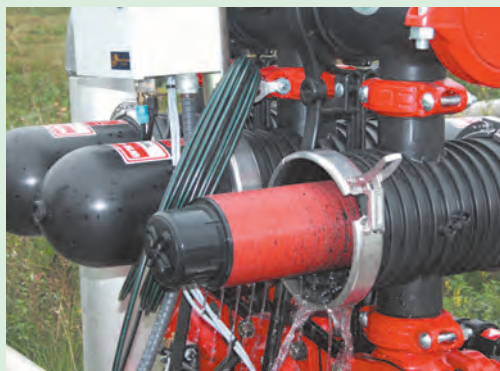
شکل ۶۰-۵. شست و شوی دستی صافی دیسکی
