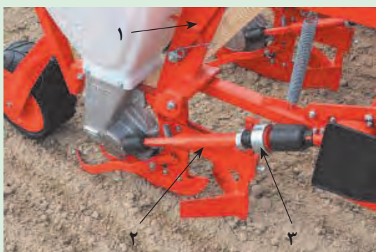
شکل ۲۷-۳. حذف واحد کارنده در یک نمونه ردیف‌کار
