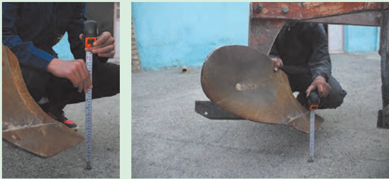
شکل ۳۰-۱. اندازه‌گیری فاصله تیغه جهت تراز عرضی
