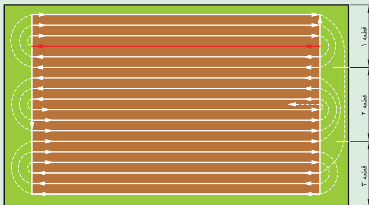
شکل ۳۸-۱. اجرای شخم به روش مداوم
