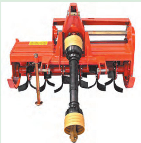
شکل ۲۵-۱. گاردان متصل به رتیواتور
