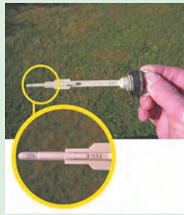
شکل ۵۷-۴. بازدید روغن موتور و شمع موتور
