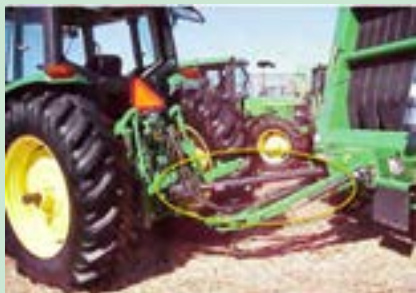
شکل ۹-۴- اتصال شیلنگ‌های هیدرولیک
