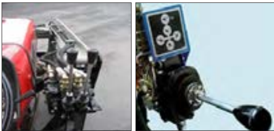
(الف) (ب) شکل ۳۰-۴-۱ اهرم کنترل بیل
