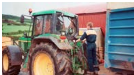
شکل ۱۶-۴ خطر ایستادن روی مالبند پی‌نورد و تراکتور
