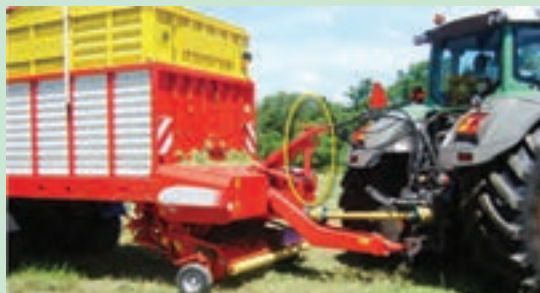
شکل ۹-۴- اتصال شیلنگ‌های هیدرولیک
