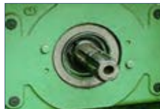
شکل ۶۹-۳- محور تواندهی ۶ خار
