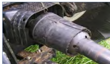
شکل ۳-۷۳- گاردان مجهز به کلاچ یک‌طرفه
