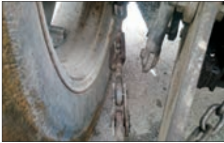
شکل ۷۸-۳- تنظیم زنجیر مهار کننده
