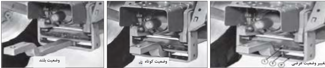
شکل ۵۷-۳- تنظیمات مالبند قابل تنظیم
