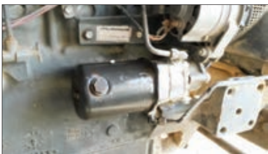
شکل ۴۰-۳- محل بازدید روغن پمپ فرمان تراکتور فرگوسن ۲۸۵
